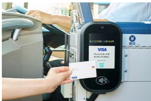
設置したタッチ決済用リーダー (レシップ製キャッシュレス運賃収受器「LV-700」)
